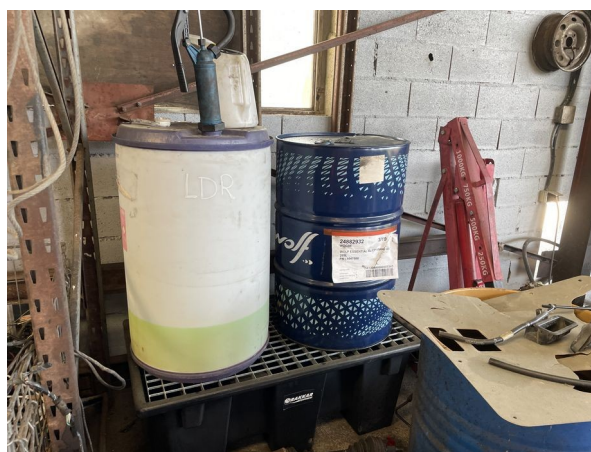
Situation au 10/06/2025 : Rétentions mises en place
